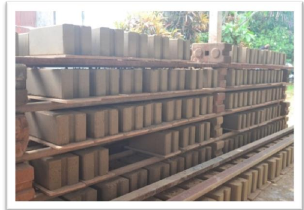
ภาพที่ 5 ก่อนตัวอย่างอิฐบล็อกประสานหลังจากการขึ้นรูปอิฐบล็อกประสาน
