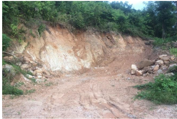
ภาพที่ 3 ดินลูกรัง จากบ่อดินในพื้นที่ ตำบลท้องเนียน อำเภอนอม จังหวัดนครศรีธรรมราช
