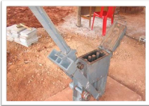
ภาพที่ 4 การอัดอิฐบล็อกประสานแบบมือโยก (Cinva Ram)
