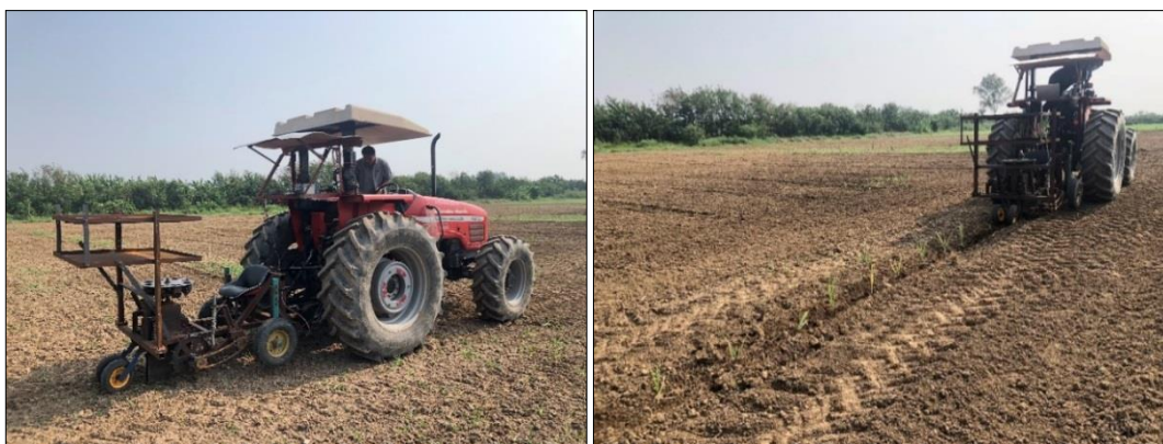
ภาพที่ 13 ลักษณะการทำงานของเครื่องปลูกกล้าอ้อย
