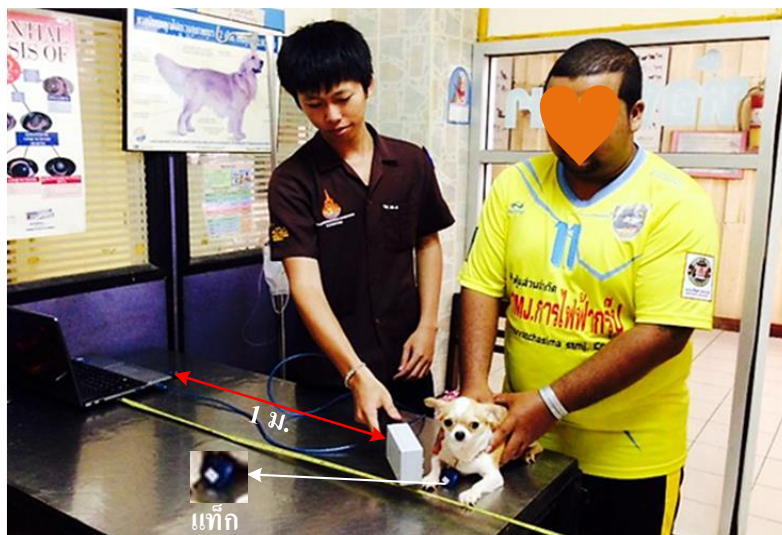
ภาพที่ 13 การทดสอบการอ่านแท็กที่ติดกับตัวสัตว์ (สุนัข)
