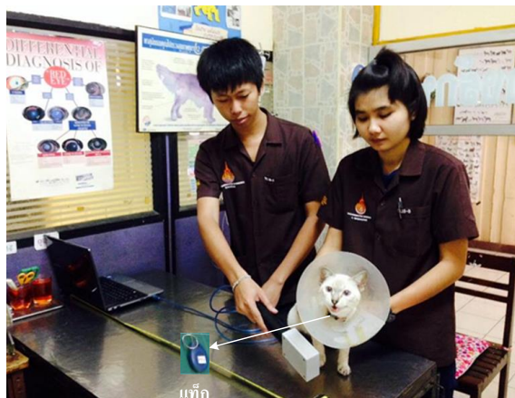
ภาพที่ 8 การใช้เครื่องอ่านอาร์เอฟไอดีที่ได้ทำการออกแบบเพื่ออ่านแท็กที่ติดกับตัวสัตว์เลี้ยง
