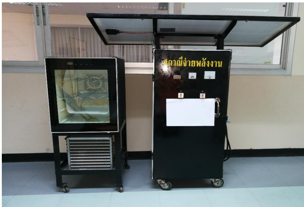
ภาพที่ 2 เครื่องต้นแบบตู้เย็นพลังงานแสงอาทิตย์
