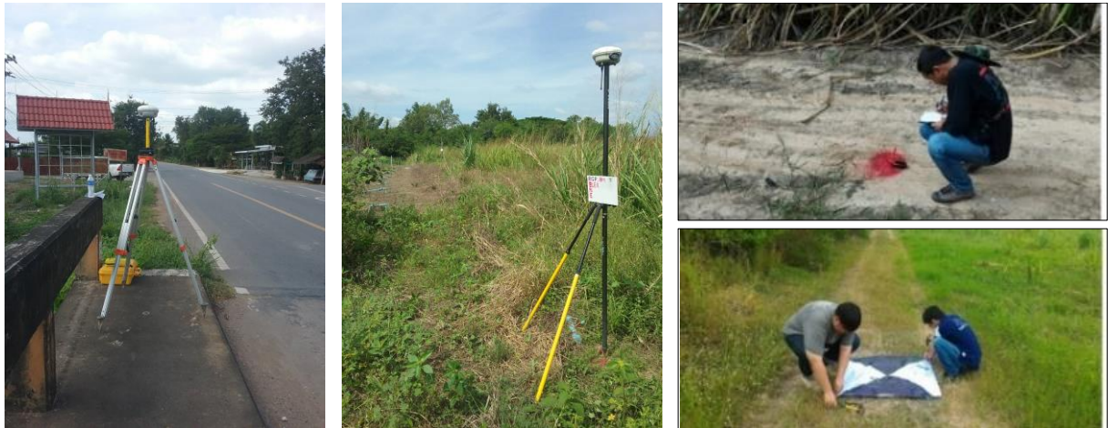
ภาพที่ 2 การเก็บตำแหน่งจุดควบคุมภาคพื้นดิน (GCPs)
