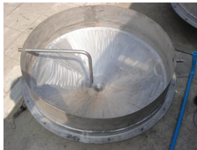
ภาพที่ 3 ฝาควบคุมแน่นถังกลั่นเอทานอลพลังงานรังสีแสงอาทิตย์แบบเทอร์โมโซลาร์
