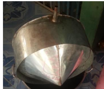
ภาพที่ 3 ฝาควบคุมแน่นถังกลั่นเอทานอลพลังงานรังสีแสงอาทิตย์แบบเทอร์โมโซลาร์
