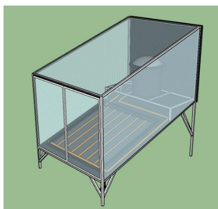
ภาพที่ 2 ตู้อบพลังงานรังสีอาทิตย์แบบเทอร์โมไซฟอนและตัวเก็บรังสีอาทิตย์แบบแผ่ราบ
