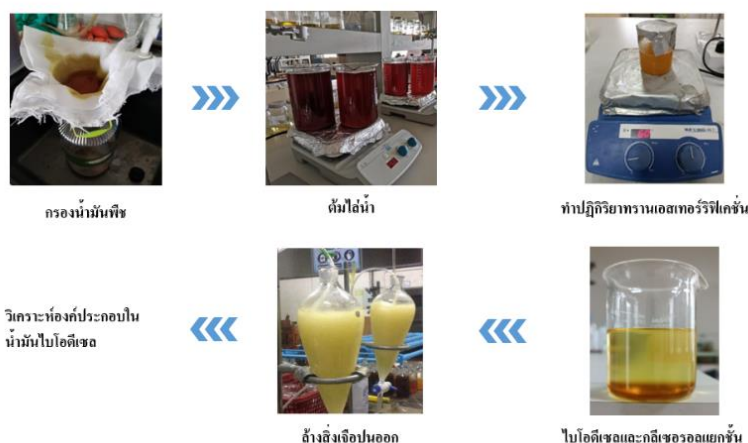
ภาพที่ 1 แสดงขั้นตอนการผลิตไบโอดีเซลจากน้ำมันพืชใช้แล้วด้วยกระบวนการทรานส์เอสเทอร์ริฟิเคชัน
