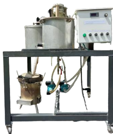
ภาพที่ 2 ระบบผลิตน้ำมันไบโอดีเซลจากน้ำมันพืชใช้แล้วโดยใช้ความร้อนจากเตาชีวมวล
