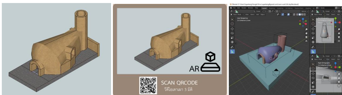
ภาพที่ 4 แสดงการออกแบบเตาอินทิล ออกแบบมาร์กเกอร์ และพัฒนาโมเดล 3 มิติ
