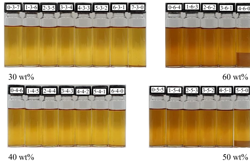
ภาพที่ 5 พฤติกรรมเฟสที่อุณหภูมิห้องของเชื้อเพลิงผสม CHSD-PEPFAD-AhE ที่สัดส่วนการผสม PEPFAD ต่าง ๆ หมายเหตุ: หมายเลขบนฝาขวดแสดงถึงสัดส่วนการผสม เช่น เชื้อเพลิงผสม 0-0-10 หมายถึงมีสัดส่วนการผสมที่ CHSD 0 wt%, PEPFAD 0 wt% และ AhE 10 wt%
