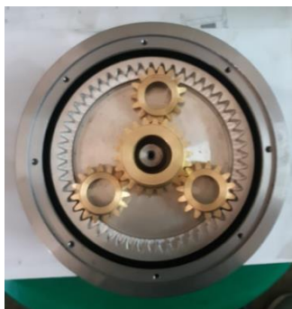
ภาพที่ 2 ชุดเฟืองแพลนเนตารีที่ได้จากกระบวนการศึกษาตามหลักวิศวกรรมย้อนรอย
