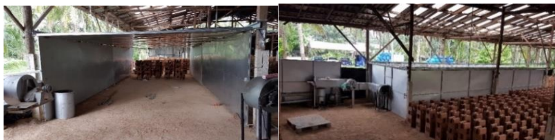
ภาพที่ 3 การสร้างและการประกอบติดตั้งต้นแบบระบบควบคุมลมร้อนที่โรงงานผลิตอิฐแดง
