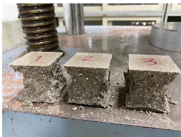
ภาพที่ 7 ตัวอย่างของมอร์ตาร์จีโอโพลิเมอร์ที่แข็งตัวแล้วและผ่านการทดสอบกำลังอัด
