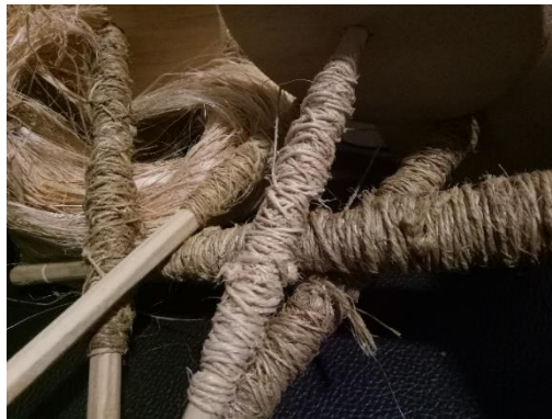
ภาพที่ 3 เชือกกล้วยที่ผ่านกระบวนการเข้าเกลียวเชือกด้วยเครื่องปั่นเส้นใยแบบมือหมุน
