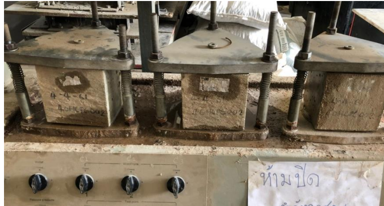
ภาพที่ 3 การทดสอบการต้านทานการซึมผ่านของน้ำตามมาตรฐาน DIN 1048: Teil 5 (1991)
