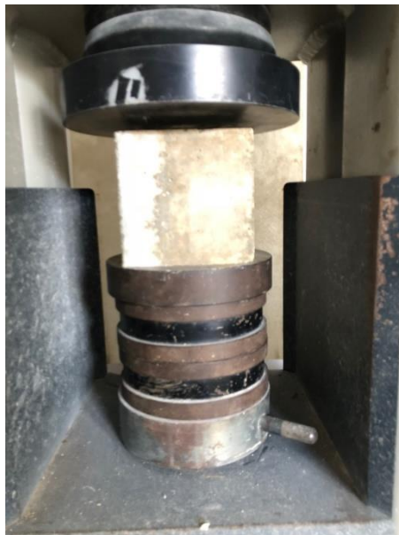
ภาพที่ 4 การทดสอบกำลังรับแรงอัดของก้อนตัวอย่างรูปทรงลูกบาศก์
