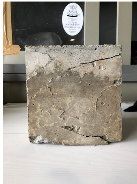
ภาพที่ 4 การทดสอบกำลังรับแรงอัดของก้อนตัวอย่างรูปทรงลูกบาศก์
