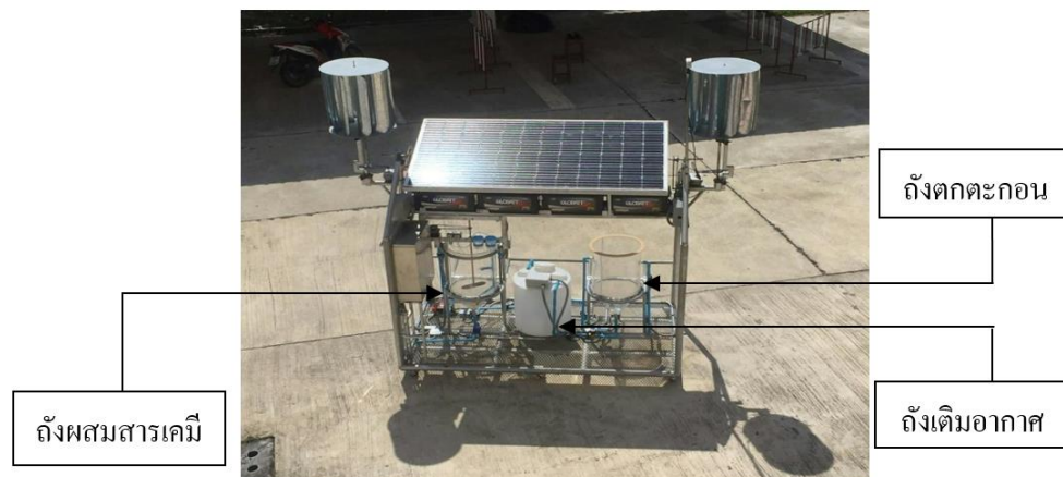
ภาพที่ 6 ลักษณะของชุดบำบัดน้ำเสียด้วยพลังงานแสงอาทิตย์และพลังงานลม
