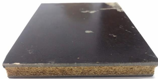
(ก) ชิ้นงานทดสอบสมบัติการป้องกันเสียง
