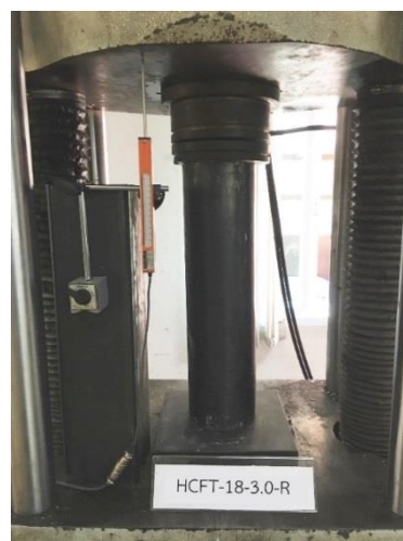
ภาพที่ 1 การติดตั้งตัวอย่างทดสอบเสา
