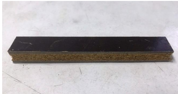
(ข) ชิ้นงานทดสอบสมบัติการดัด
