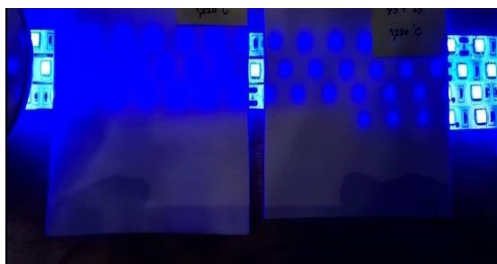
ภาพที่ 8 เปรียบเทียบความโปร่งแสงซ้ายมือโบนาไซนาต้นแบบและขวามือสารตั้งต้น 30 เปอร์เซนต์ เนื้อดิน 70
