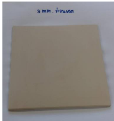
ภาพที่ 6 แผ่นทดสอบเมื่อนำออกจากแบบพิมพ์ปูนปลาสเตอร์
