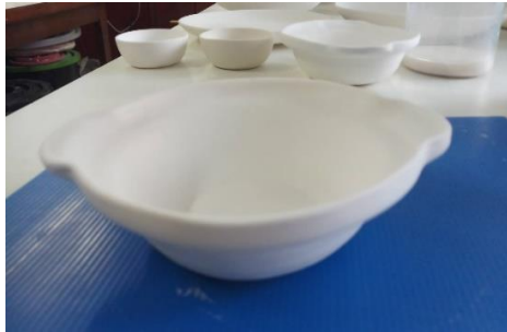
ภาพที่ 10 เมื่อผ่านกระบวนการทางความร้อนที่อุณหภูมิ 1,200 องศาเซลเซียส เนื้อดินจะเป็นสีขาวมากที่สุด
