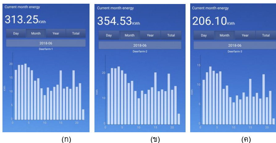
ภาพที่ 8 (ก) ผลการสอบวัดค่าพลังงานไฟฟ้า ที่เซลล์แสงอาทิตย์ผลิตได้ที่จุดที่ 1 กรงกวางด้านหน้าฟาร์มกวาง (ข) ผลการสอบวัดค่าพลังงานไฟฟ้า ที่เซลล์แสงอาทิตย์ผลิตได้ที่จุดที่ 2 กรงกวางด้านหลังฟาร์มกวาง (โรงเพาะเลี้ยงที่ 2) (ใช้กับปั๊มสูบน้ำ 2 เครื่อง) และ (ค) ผลการสอบวัดค่าพลังงานไฟฟ้า ที่เซลล์แสงอาทิตย์ผลิตได้ที่จุดที่ 3 อาคารแซ่เนื้อกวาง (หมายเหตุ ในรูปผลการทดสอบ แนวแกน x คือ วันที่ในเดือนนั้น และแนวแกน y คือ พลังงานไฟฟ้าปัจจุบันในเดือนนั้น)
