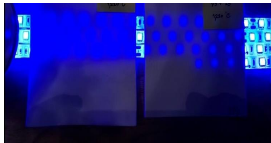
ภาพที่ 8 เปรียบเทียบความโปร่งแสงซ้ายมือโบนไซนาต้นแบบและขวามือสารตั้งต้น 30 เปอร์เซ็นต์ เนื้อดิน 70
