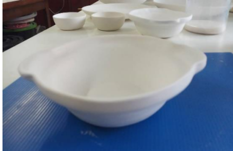
ภาพที่ 10 เมื่อผ่านกระบวนการทางความร้อนที่อุณหภูมิ 1,200 องศาเซลเซียส เนื้อดินจะเป็นสีขาวมากที่สุด
