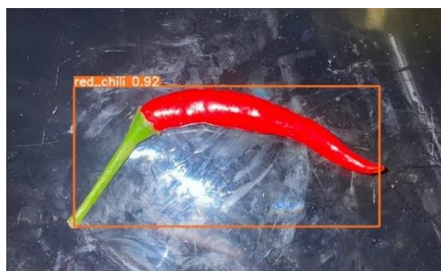
ภาพที่ 10 แสดงผลของการ test พริกสีแดงด้วยสภาพแวดล้อมที่มีแสงมากเกินไป
