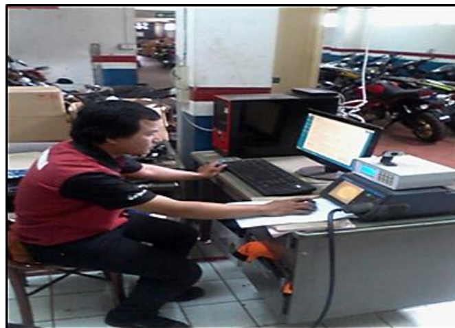
ภาพที่ 11 วิเคราะห์แก๊สไอเสียของรถจักรยานยนต์
