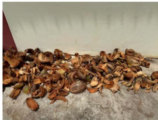
ภาพที่ 1 ลักษณะของเปลือกมะพร้าว ที่ผ่านการตากแห้งก่อนนำไปกระบวนการเผาไหม้แบบคาร์บอนไนซ์
