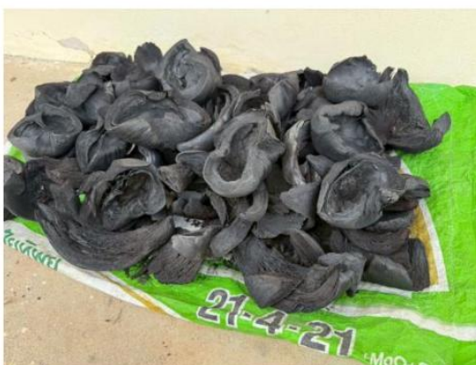
ภาพที่ 2 ลักษณะทางสัณฐานวิทยาของถ่านกัมมันต์ที่ผลิตจากเปลือกมะพร้าว
