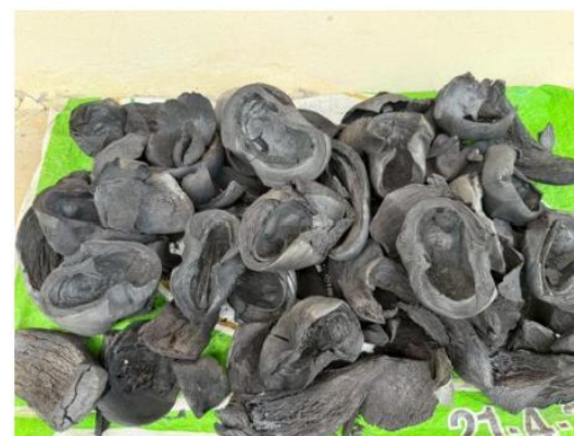
ภาพที่ 2 ลักษณะทางสัณฐานวิทยาของถ่านกัมมันต์ที่ผลิตจากเปลือกมะพร้าว
