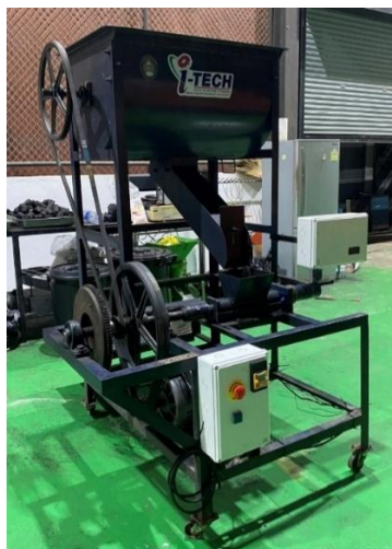
ภาพที่ 3 เครื่องผสมและอัดถ่านแท่งต้นแบบที่สร้างเสร็จ
