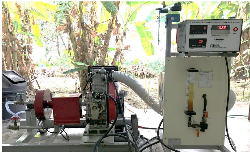
ภาพที่ 1 เครื่องยนต์ดีเซลและชุดทดสอบสมรรถนะเครื่องยนต์ ตารางที่ 3 ข้อมูลทางเทคนิคของเครื่องยนต์ดีเซลที่ใช้ในการทดสอบ [19]
