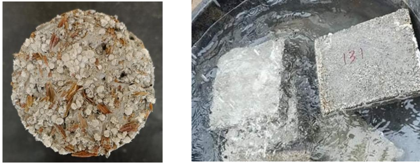
ภาพที่ 4: การทดสอบอัตราการดูดซึมน้ำของแผ่นคอนกรีตน้ำหนักเบา
