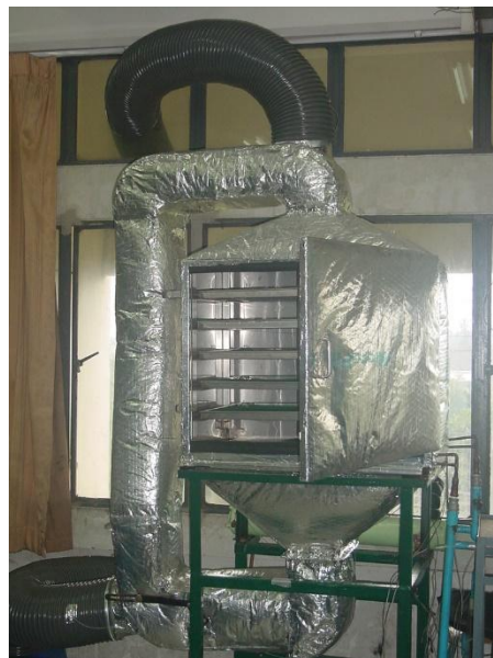
ภาพที่ 2 แสดงแบบตู้อบแห้งวัตถุดิบผลิตเครื่องดนตรีอีสานด้วยพลังงานความร้อนทั้งจากเครื่องปรับอากาศ
