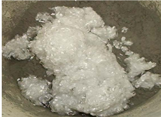
รูปที่ 1. ไมโครไฟเบอร์ ที่ผสมกับปูนซีเมนต์สัดส่วน 0%, 0.5%, 1.0%, 1.50% 2.0% และ 2.5% โดยน้ำหนักของปูนซีเมนต์
