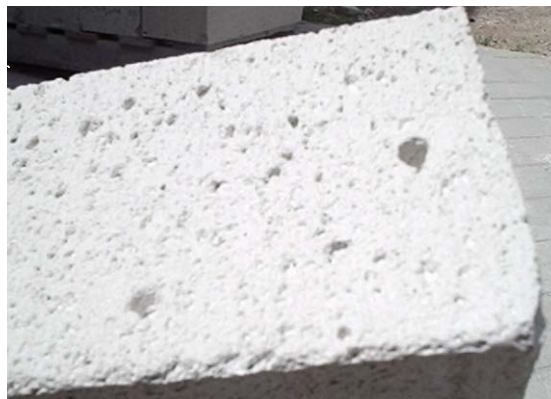
รูปที่ 2. ตัวอย่างชิ้นส่วนคอนกรีตมวลเบาแบบมีฟองอากาศ - อบไอ้แบบผสมไมโครไฟเบอร์
