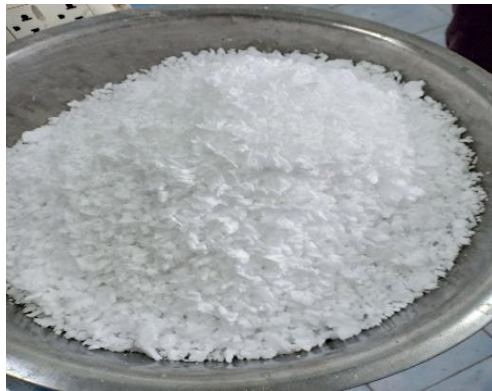
รูปที่ 2. โฟมพอลิโพรพิลีนที่ได้จากการปั่นย่อย
