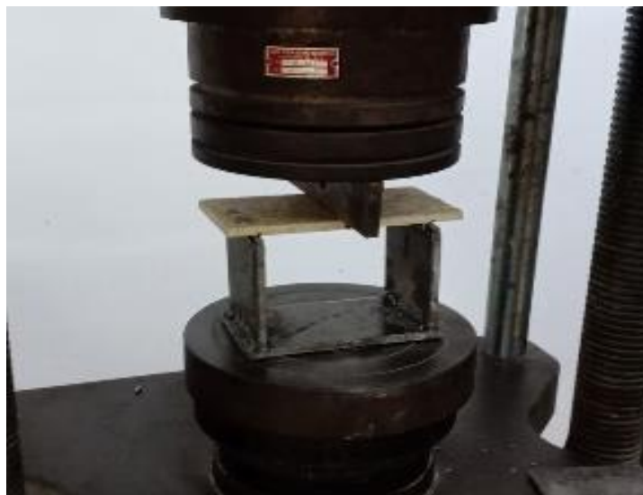
รูปที่ 4. การทดสอบความต้านทานแรงดัดแบบ 3 จุดของแผ่นใยไม้อัดจากเปลือกของลำต้นทานตะวัน
