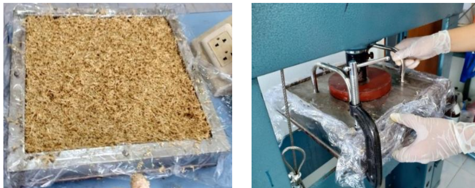
รูปที่ 3. (ก) การเตรียมอัดขึ้นรูป และ (ข) ขึ้นรูปด้วยเครื่องอัดไฮดรอลิก
