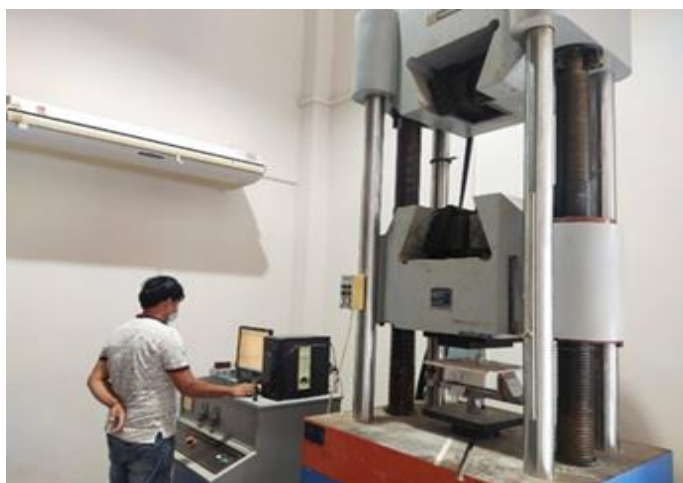
รูปที่ 3. เครื่องทดสอบ Universal Testing Machine (UTM)
