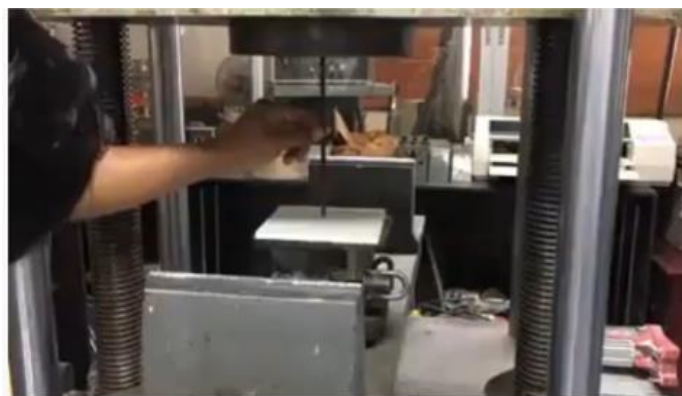
รูปที่ 7. การทดสอบแรงต้านทานการดัดงอ
