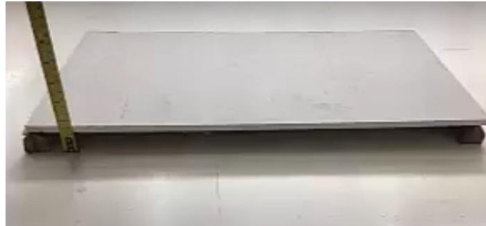
รูปที่ 5. การทดสอบการแอ่นตัว
