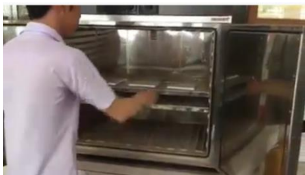
รูปที่ 4. การอบตัวอย่างเพื่อทดสอบการดูดซึมน้ำ
