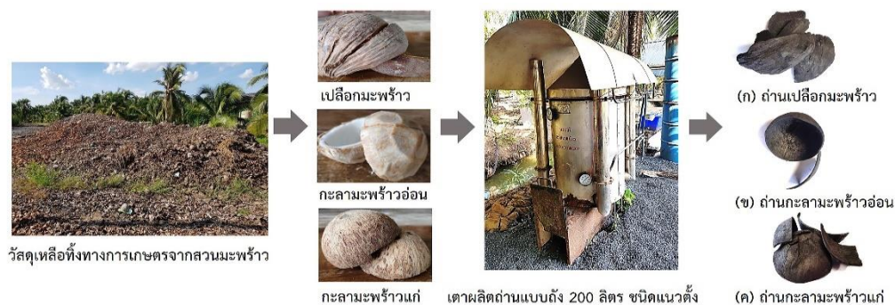
รูปที่ 1. กระบวนการเตรียมถ่านที่ได้จากวัสดุเหลือทิ้ง (ก) ถ่านเปลือกมะพร้าว (ข) ถ่านกะลามะพร้าวอ่อน และ (ค) ถ่านกะลามะพร้าวแก่
