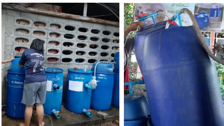
รูปที่ 1. ชุดการทดลองแบบไร้อากาศในห้องปฏิบัติการ
