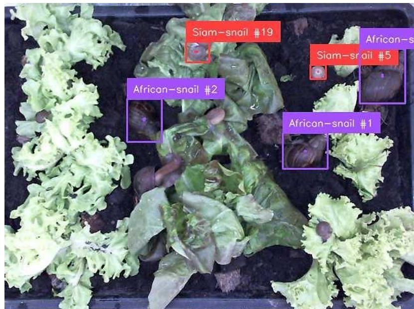
รูปที่ 11. การตรวจจับหอยทากบกที่แสดงชื่อสายพันธุ์และแท็กตัวเลขที่ใช้ในการติดตามหอยทากแต่ละตัว โดยที่กรอบสีแดงหมายถึงระบบตรวจจับหอยทากสยามได้ และกรอบสีม่วงหมายถึงระบบตรวจจับหอยทากยักษ์แอฟริกันได้ หมายเหตุ ภาพนี้ถูกสุ่มจากกล้องเว็บแคมที่ใช้ในงานวิจัยจึงทำให้สังเกตเห็นหอยทากสยามบางตัวไม่ชัดเจน
