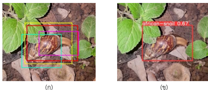
รูปที่ 2. การตรวจจับหอยทากในวิดีโอเฟรมโดยใช้โมเดล YOLO ที่กำหนดค่า IoU = 0.5 (ก) ผลการทำนายวัตถุในภาพก่อนใช้เทคนิค NMS ซึ่งโมเดลแสดงกล่องขอบเขตมากกว่า 1 กล่องขอบเขต (ข) หลังการใช้เทคนิค NMS โมเดลจะแสดงกล่องขอบเขตที่เหมาะสมเพียงกล่องขอบเขตเดียว หมายเหตุ: ผู้วิจัยกำหนดให้แสดงชื่อคลาสของวัตถุ (ข้อความ african-snail) และค่าคะแนนความเชื่อมั่น (ตัวเลข 0.67) ที่โมเดลคำนวณได้ไว้ที่ด้านบนของกล่องขอบเขต
