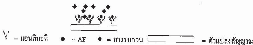
ภาพที่ 3. หลักการทำงานของอิมมูโนเซนเซอร์ คัดแปลงจาก (Paniel et al. , 2010)
