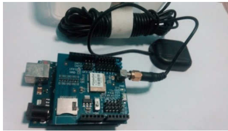
รูปที่ 2. การประกอบ GPS Shield และ GPS Antenna กับบอร์ด Arduino UNO R3
