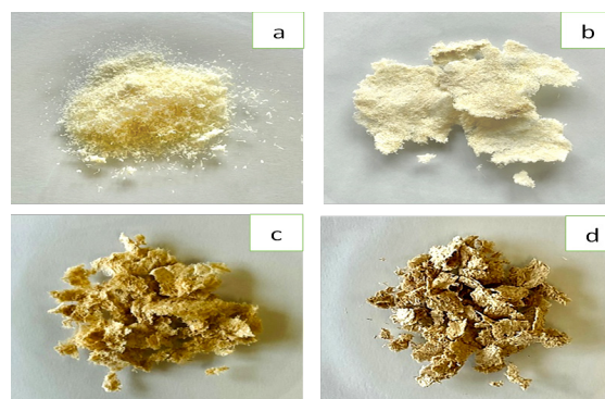
Figure 5 Characteristics of cellulose phosphate at different temperatures. (a) 100°C (b) 120°C (c) 150°C และ (d) 180°C
