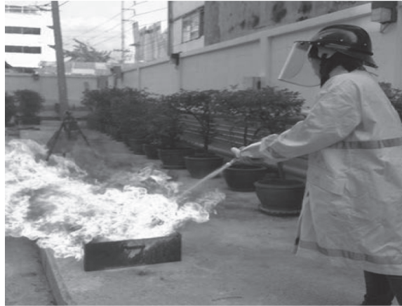
ภาพที่ 2 การทดสอบประสิทธิภาพโฟมโปรตีนสกัดจากกากเนื้อในเมล็ดยางพาราในภาคสนาม
