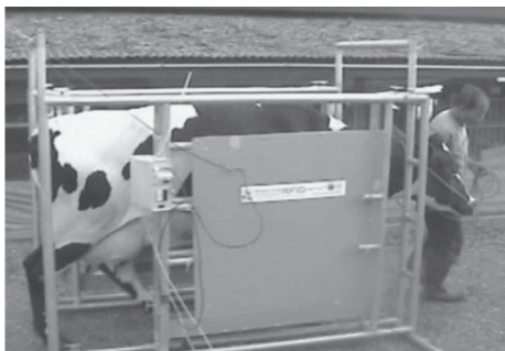
ภาพที่ 6 ภาพถ่ายสายอากาศแบบบ่วงคู้ในสภาพการใช้งานจริงกับโค (ที่มา: Torrungrueng & Phongcharoenpanich, 2014)
