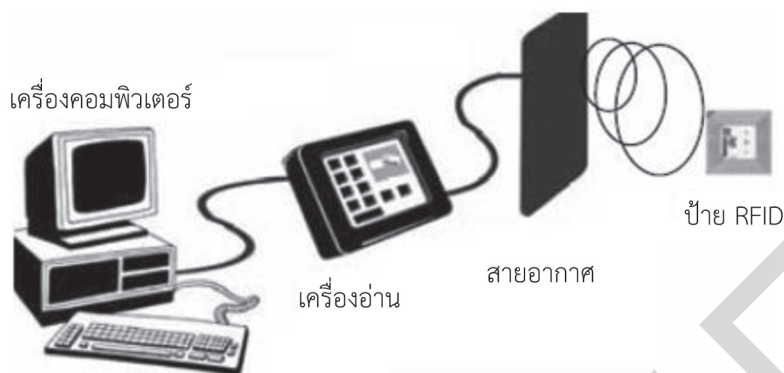
ภาพที่ 1 องค์ประกอบของระบบเทคโนโลยี RFID (ที่มา: Saengpaeng & Asasongtham, 2011)
