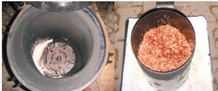
ภาพที่ 2 ถังสแตนเลสชั้นใน ถังเหล็กชั้นนอก และส่วนประกอบของเครื่องผลิตน้ำส้มควันไม้
