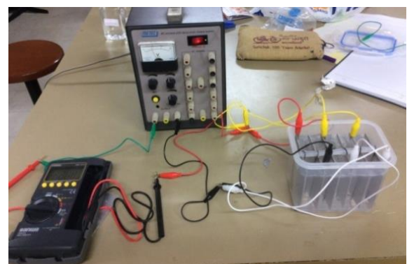
รูปที่ 3 การจัดอุปกรณ์ทดลองการกำจัดความกระด้างของน้ำ
