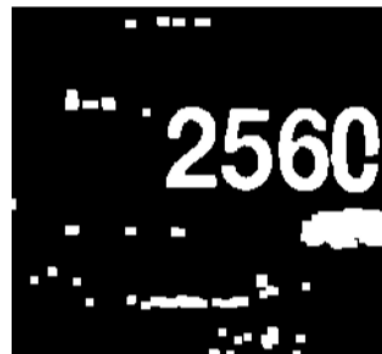
รูปที่ 8 ป้ายภาษีหลังจากผ่านเทคนิค Erode และ Dilatation
