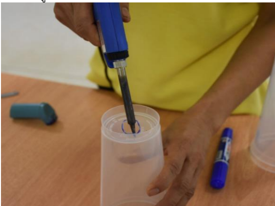
รูปที่ 9 ขั้นตอนการตัดแก้วด้วยอุปกรณ์หัวแรง
