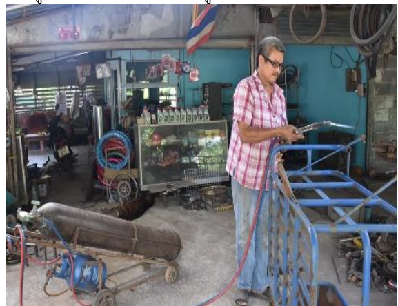
รูปที่ 4 การเผาเหล็กกลวงด้วยความร้อน
