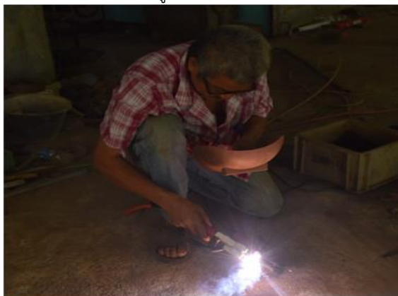
รูปที่ 6 เชื่อมด้ามจับเข้ากับเหล็กกลวง
