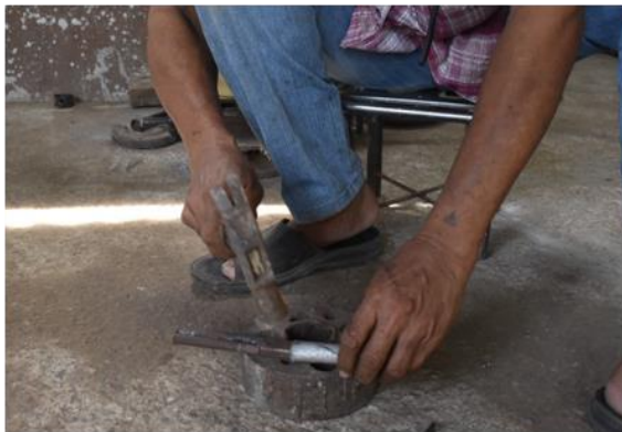
รูปที่ 5 การตีเหล็กกลวง
