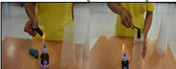
รูปที่ 10 การเจาะแก้วพลาสติกด้วยอุปกรณ์เหล็กกลวงประดิษฐ์
