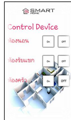
รูปที่ 15 หน้าจอระบบปฏิบัติการแอนดรอยด์ (Android OS) ที่ควบคุมตัวอย่างอุปกรณ์ไฟฟ้าภายในห้องพักอาศัย
