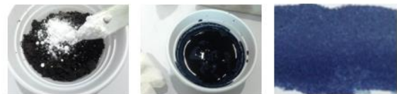
รูปที่ 6 การเปลี่ยนแปลงของสีหลังไทเทรตและนำสำลีมา ดูดสีเพื่อลดความแปรปรวนของสี
