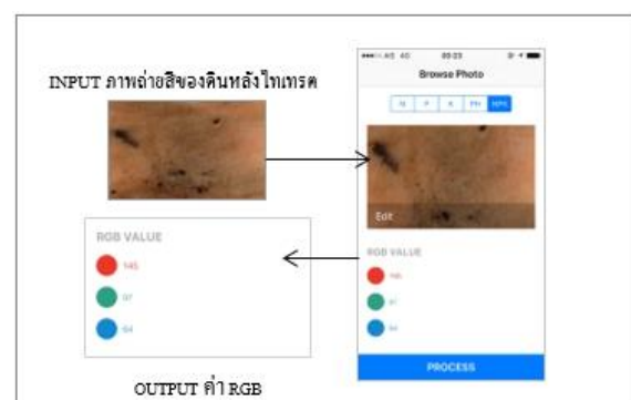
รูปที่ 15 การตรวจจับสีจากภาพถ่ายดินด้วยแอปพลิเคชันวิเคราะห์คุณภาพดิน
