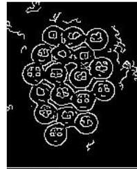
วิธีหาขอบภาพแบบ Canny
