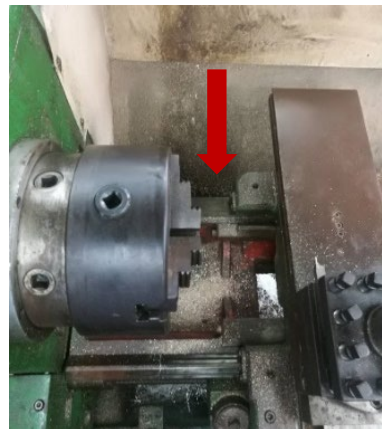
รูปที่ 3 จุดที่เศษงานกลึงค้างตกอยู่ (ฐานรองใต้ปากกาคับชิ้นงาน)
