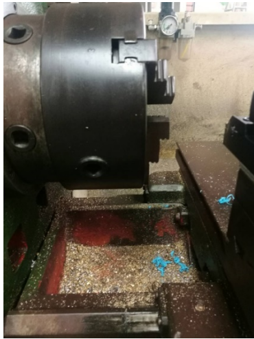
รูปที่ 15 ร่องแท่นกลึงก่อนติดตั้งอุปกรณ์กำจัดเศษงานกลึงหน้าแท่นกลึง
