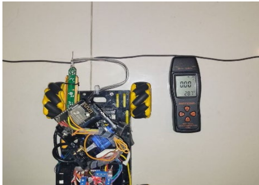
รูปที่ 19 ทดสอบตรวจจับสนามแม่เหล็กไฟฟ้า
