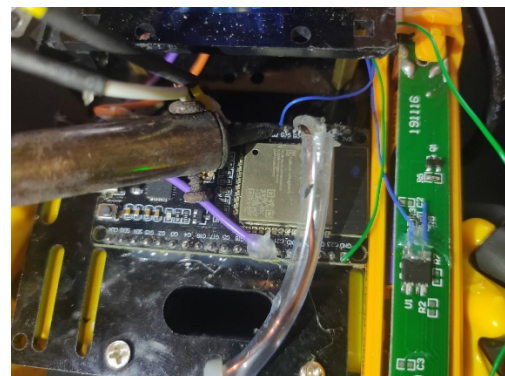
รูปที่ 9 ต่อวงจรเข้า Board ESP32 WROOM-32D
