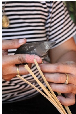
รูปที่ 3 กระบวนการจักตอกไม้ไผ่ด้วยมือ
