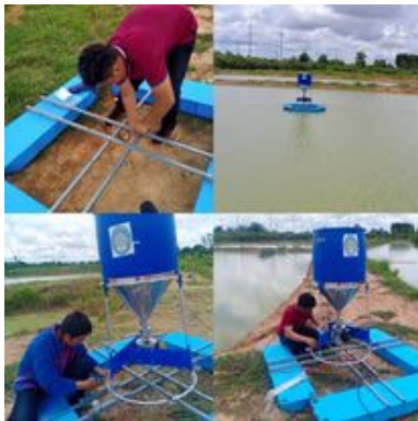
รูปที่ 3 การทดลองประกอบถังใส่อาหารกุ้งแบบ สแตนเลส 304 และทดสอบเหยื่ออาหารในฟาร์ม ทดสอบ
