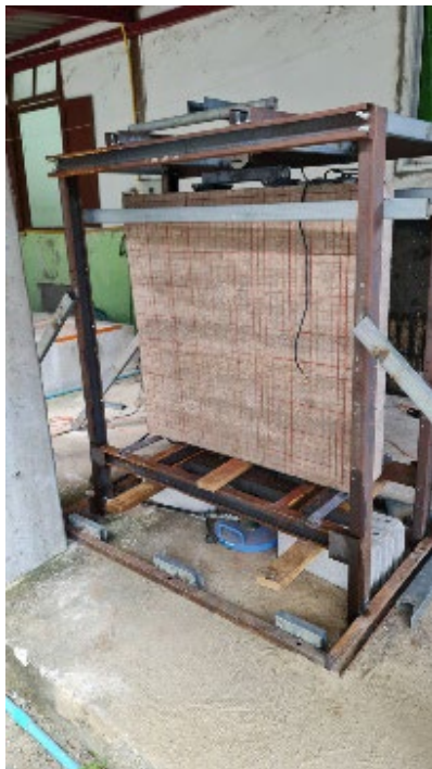
รูปที่ 4 ติดตั้งตัวอย่างกับเครื่องทดสอบกำลังดัด
