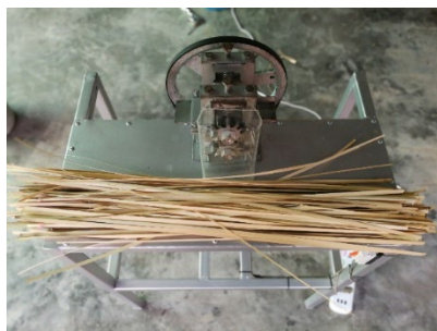
รูปที่ 6 ตอกไม้ไฟ ที่ผ่านการจักด้วยเครื่อง
