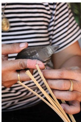
รูปที่ 3 กระบวนการจักตอกด้วยมือ
