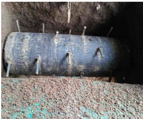
รูปที่ 4 ชุดตีก่อนของเครื่องตีก่อนเห็ดแบบตัดเชือกอัตโนมัติ
